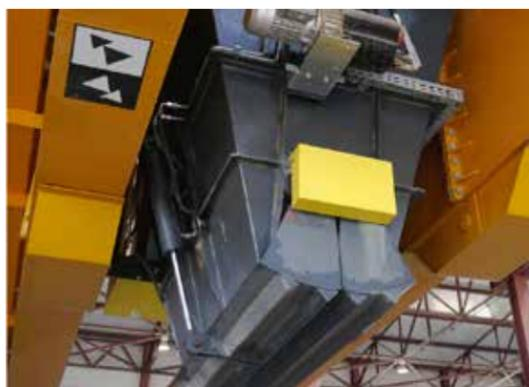
Конструкция завода включает ряд специальных элементов: планетарный смеситель объемом 3000/2000 л оснащен тремя выгрузками, две из которых предназначены для выгрузки на две разные линии по изготовлению изделий, а третья — для товарного бетона. Для обеспечения производства высококачественного бетона применяется система точной дозировки инертных материалов, а также датчики влажности материалов в бункерах и смеси в смесителе.
